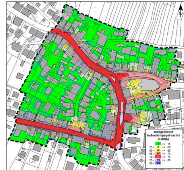
Abbildung 9 – Kennzeichnung Lärmpegelbereiche nach DIN 4109
